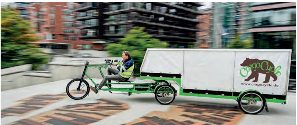
*Lastenrad als Sattelschlepper*
